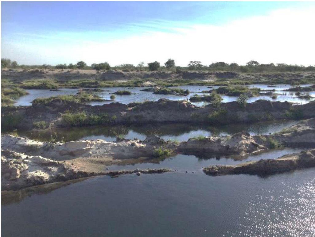
Área de explotación (sector Triángulo). Aunque no llegan al piso de arcilla las cavas se llenan de agua rápidamente y la retroexcavadora ya no puede trabajar más.
