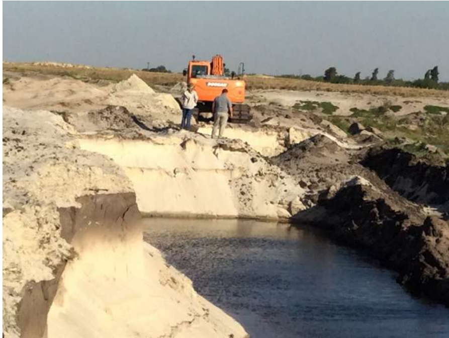
Frente de línea de cava en explotación, sector El Triángulo. Aún no han llegado al piso de arcilla.
