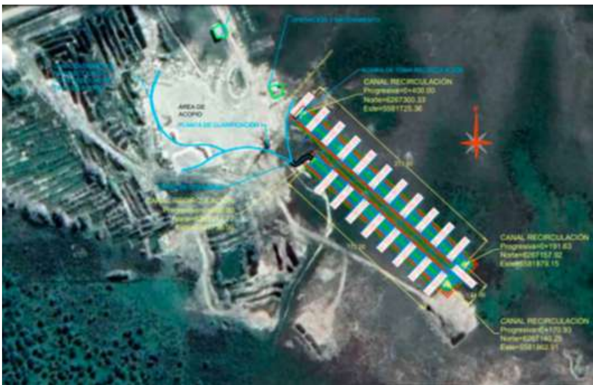
Figura V 49. Actual destino final de los efluentes de la planta: canal de sedimentación que permite reutilizar el agua en proceso.
