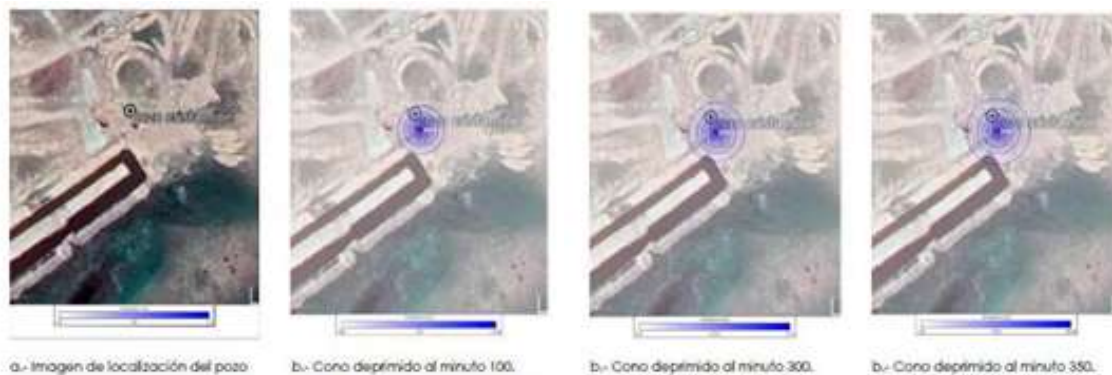
Figura V 20. Proyección en el plano horizontal del cono de depresión en distintos momentos del ensayo de bombeo.
