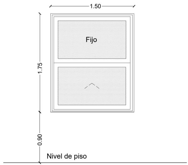
**Forma de abrir:** Ventana deslizante vertical (Guillotina). Deslizante una (1) hoja.
