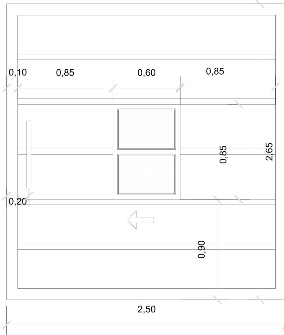
Portón corredizo manual de chapa lisa bastonada horizontal en chapa N°18. Dos manos de convertidor de óxido y dos manos de esmalte sintético color gris. Cerradura para corrediza. Manijón tipo barral de acero inoxidable de 38mm de diámetro y 600mm de largo. Ventana con dos paños fijos. Vidrio: Laminados de seguridad transparente 6 mm. de espesor, asentados con silicona.
