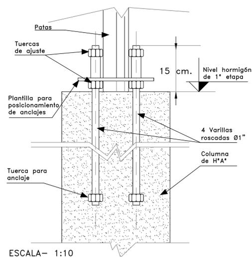
Nota: Retirar la plantilla una vez fraguado el hormigón, en el momento de montar el tanque. El comprador ejecutará un grout de segunda etapa luego de montado el tanque.
