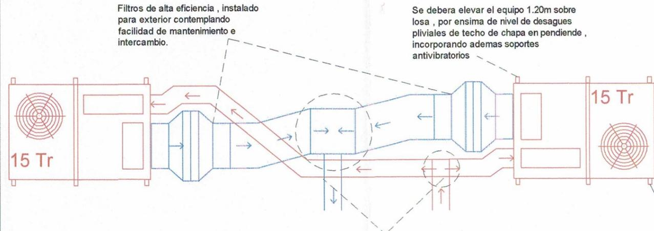
Filtros de alta eficiencia, instalado para exterior contemplando facilidad de mantenimiento e intercambio.
