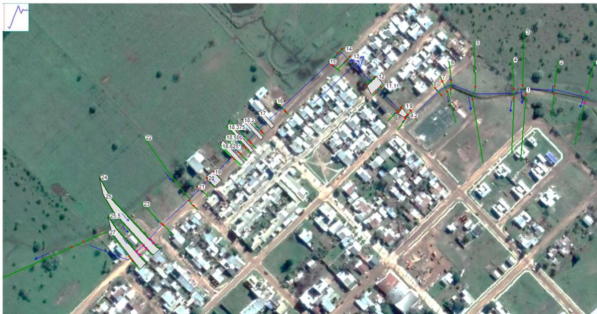
Imagen 29: Geometría en planta del modelo hidráulico
