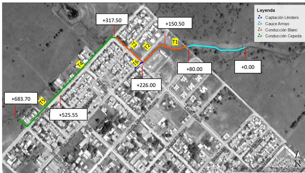
Imagen 1: Esquema conducciones propuestas
