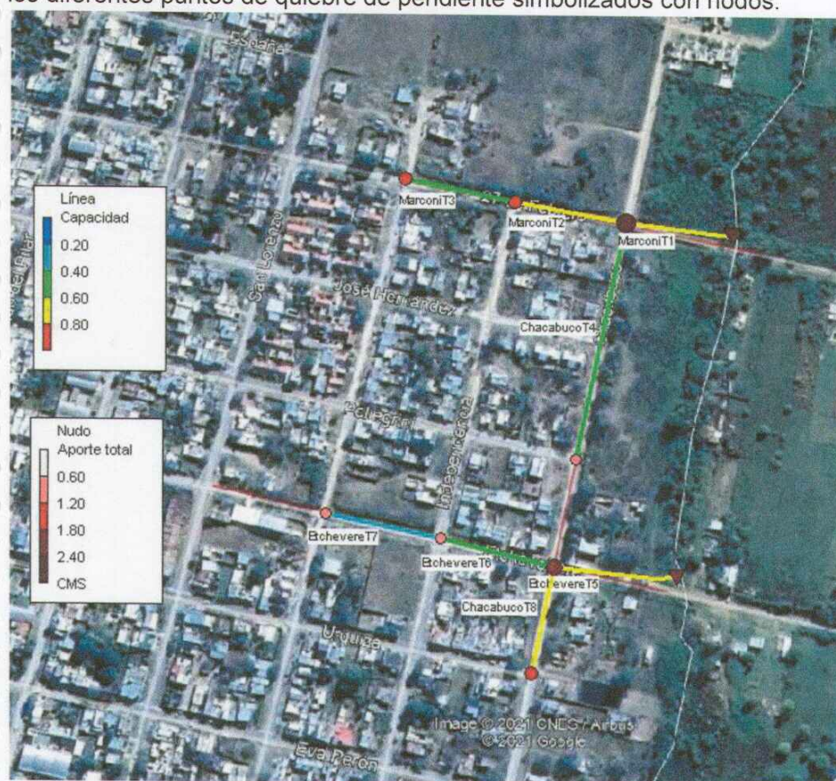
Figura 11: Resultado modelo Swmm –Capacidad y Aportes
