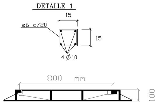
NOTA1: Tapa y marco Ø=800mm fundición dúctil para Calzada Clase D400
