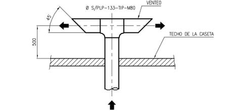
DETALLE REMATE DEL VENTEO FILTROS FM AL EXTERIOR DE LA CASETA ESC. = GRÁFICA
