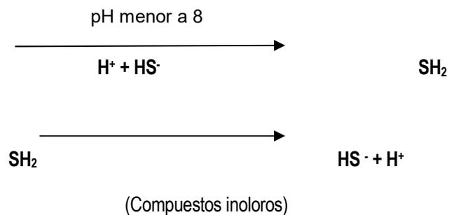
Sulfatos. Ión común en aguas residuales, se requiere para la síntesis de proteínas y se libera en su descomposición. En condiciones anaerobias originan problemas de olor y corrosión de alcantarillas como lo indican las ecuaciones anteriores. En digestores de lodos los sulfatos son reducidos a sulfuros y el proceso biológico se deteriora si la concentración de sulfuros es mayor de 200 mg/L.
