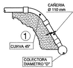
1 CONEXIÓN EN VEREDA 2 CONEXIÓN EN CALZADA
