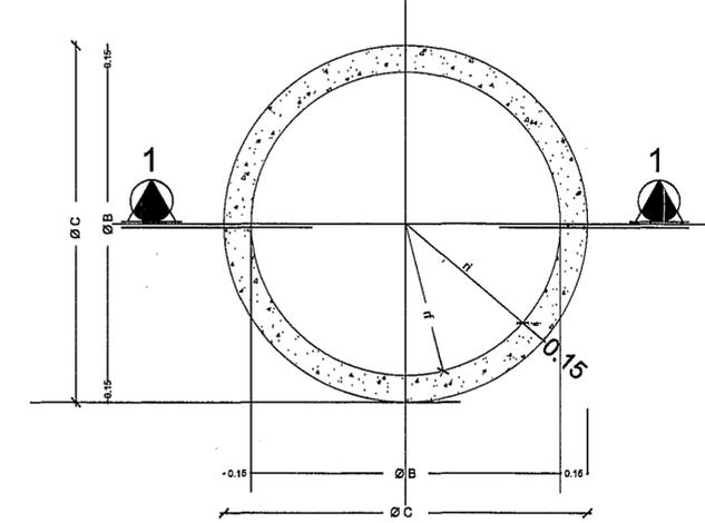
Albañilería común mezcla 1:3 (ver Corte 1)
