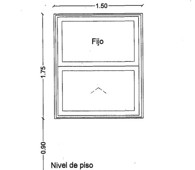
**Forma de abrir:** Ventana deslizable vertical (Guillotina). Deslizable una (1) hoja.
