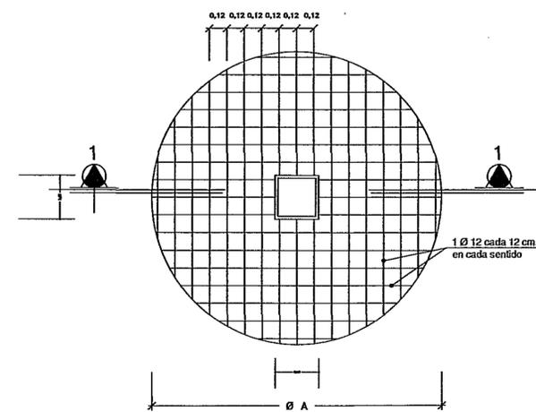
Losa de Hormigón armado de 12 cm. espesor
