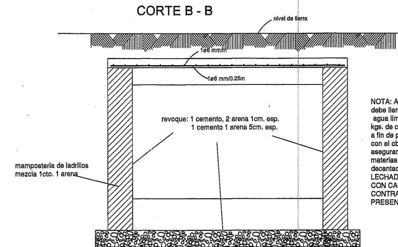
NOTA: Antes de iniciar el funcionamiento debe llenarse de agua limpia y agregarle 1 lechada con 150 kgs. de cal viva a fin de provocar la fermentación alcalina con el objeto de asegurar la evolución digestiva de las materias orgánicas decantadas (EL AGREGADO DE LA LECHADA DE AGUA CON CAL DEBERÁ EFECTUARLA EL CONTRATISTA EN PRESENCIA DE LA INSPECCION)
