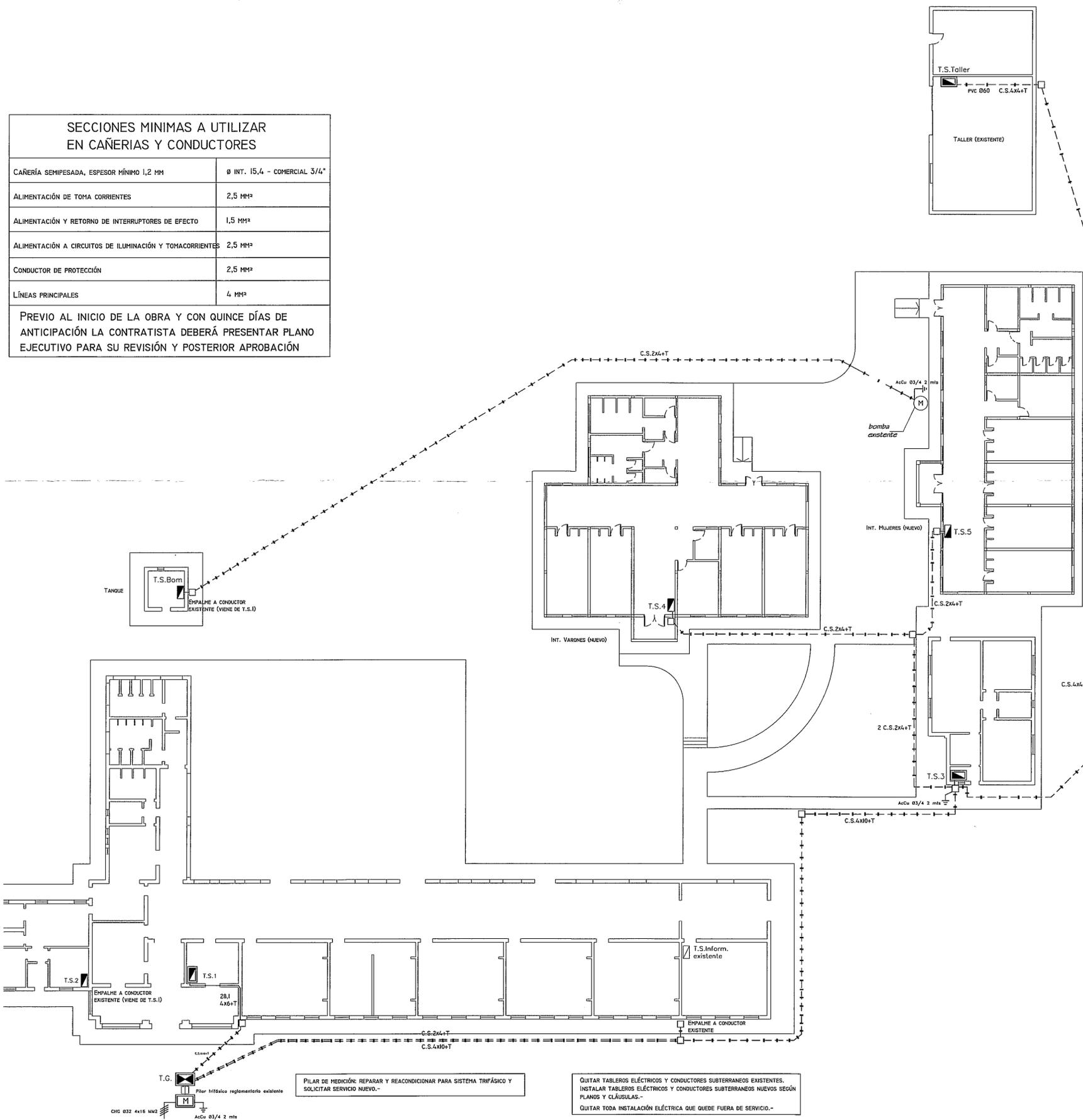
PILAR DE MEDICIÓN: REPARAR Y REACONDICIONAR PARA SISTEMA TRIFÁSICO Y SOLICITAR SERVICIO NUEVO.-
