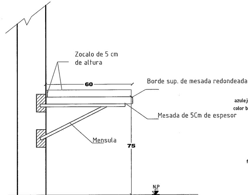
MESADAS: De viraró 2" de esp. cepillada en todas sus caras. Se admitirá una sola unión en el ancho lo que será debidamente unida a espiga y encolada
