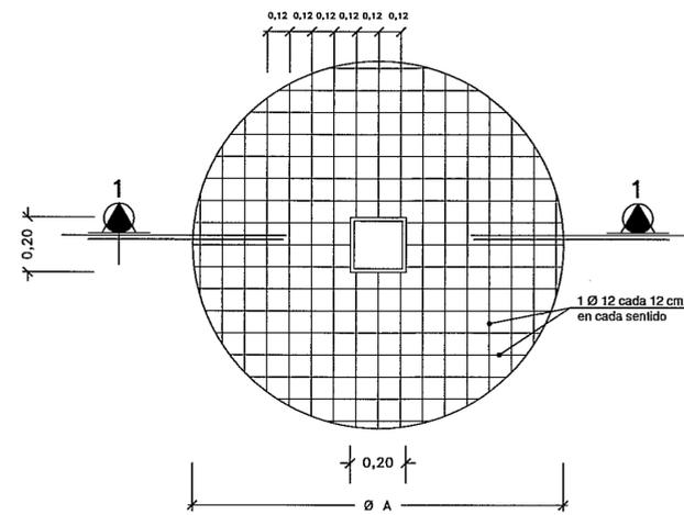
Losa de Hormigón armado de 12 cm. espesor
