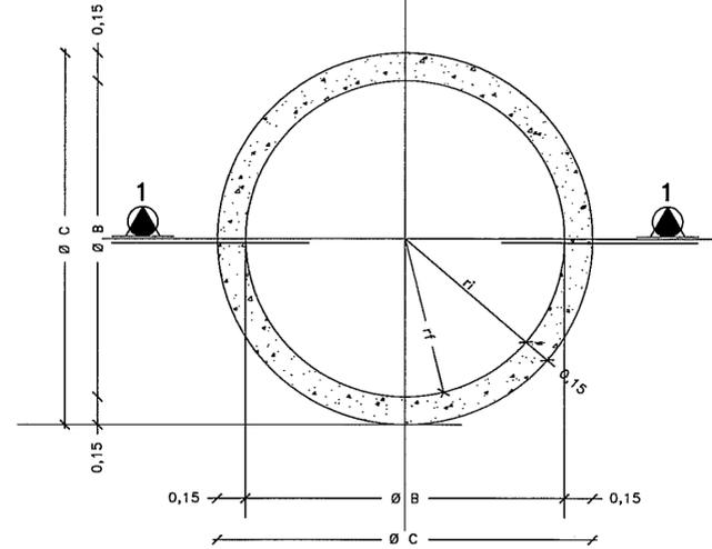
Albañilería común mezcla 1:3 (ver Corte 1)
