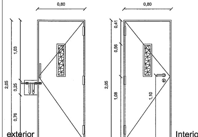
Abertura de chapa doblada Nº 12, marco: ancho de pared + 2 cm. Hoja: Doble contacto de 45 mm de espesor tablero estriado chapa doblada Nº 14 con costillas interiores. Rellena con spray de poliuretano. Tres bisagras de hierro reforzado a munición 100 mm. cerradura "ACYTRA"
