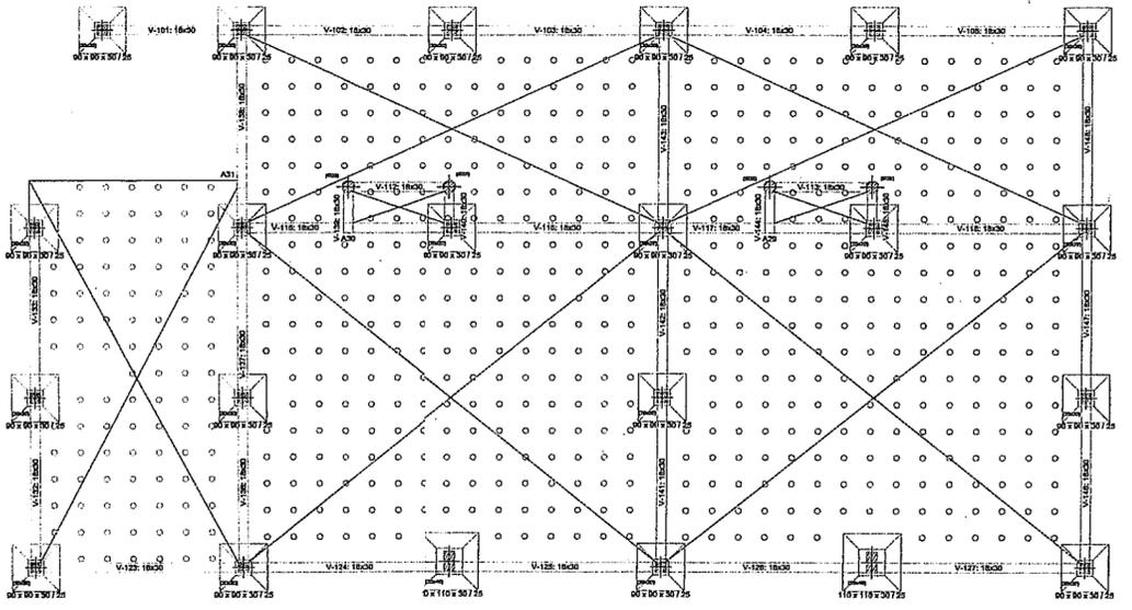
ESTRUCTURA BASES Y VIGAS DE FUNDACIÓN Esc. 1.100
