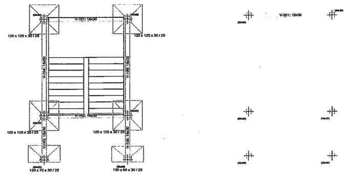
ESTRUCTURA BASES Y VIGAS DE FUNDACIÓN
