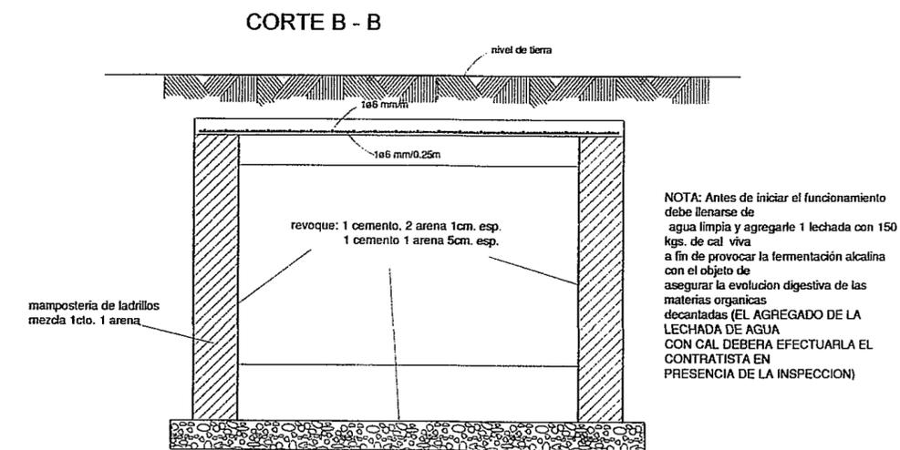
NOTA: Antes de iniciar el funcionamiento debe llenarse de agua limpia y agregarle 1 lechada con 150 kgs. de cal viva a fin de provocar la fermentación alcalina con el objeto de asegurar la evolución digestiva de las materias orgánicas decantadas (EL AGREGADO DE LA LECHADA DE AGUA CON CAL DEBERA EFECTUARLA EL CONTRATISTA EN PRESENCIA DE LA INSPECCION)
