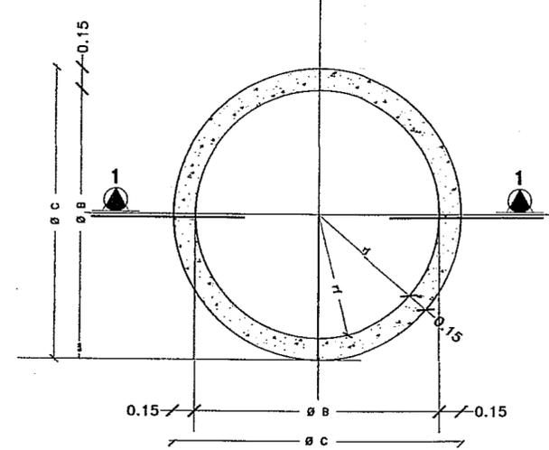
Albañilería común mezcla 1:3 (ver Corte 1)
