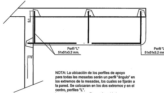
NOTA: La ubicación de los perfiles de apoyo para todas las mesadas serán un perfil "ángulo" en los extremos de la mesadas, los cuales se fijarán a la pared. Se colocaran en los dos extremos y en el centro, perfiles "L". Las uniones entre perfiles serán soldadas y amuradas con concreto.
