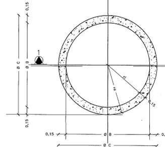
Albañilería común mezcla 1:3 (ver Corte 1)
