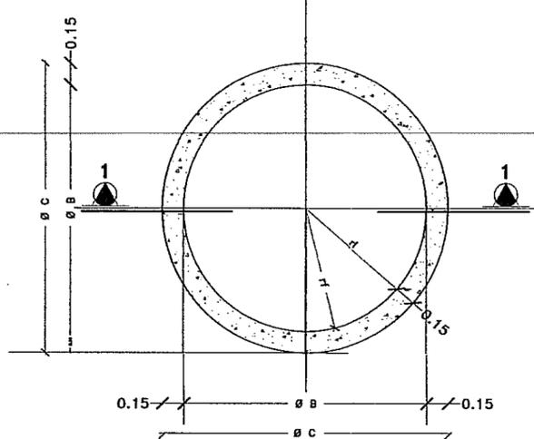
Albañilería común mezcla 1:3 (ver Corte 1)
