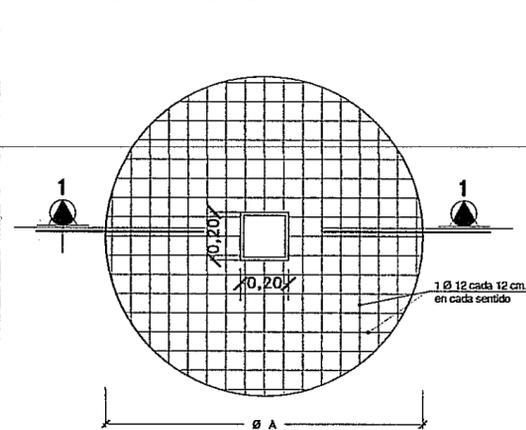
Losa de Hormigón armado de 12 cm. espesor
