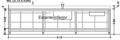
Mesada: en acero inoxidable calidad AISI 304 18/8 de 1.5 mm de espesor esmerilado, sobre base de panelco de 19 mm. Soldaduras en atmósfera de gas argón, prolijamente desbastadas y pulidas al ras. Acabado superficial pulido mate. Tendrán respaldo mural de 100 mm de altura y llevarán perfil antidesborde en todo su perímetro.
