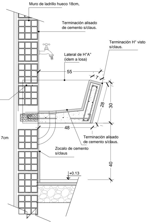
**Losa de base:** esp. minimo 7cm
