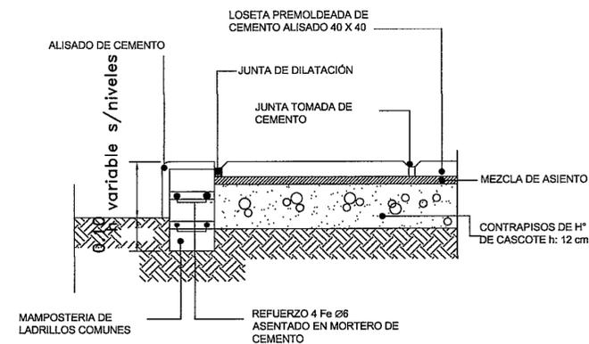
**DETALLE CIMIENTO MURO DE 0,15 ESP.**
