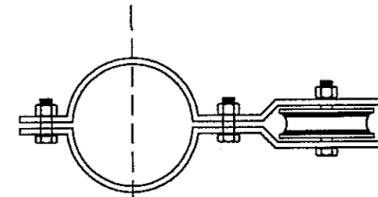
Bridas de soporte de roldanas en planchuela de 38.1x3.2 mm, largo necesario. Ajuste con 3 bulones de  $\varnothing$  6 mm, largo necesario. Arandelas comunes y de presión.
