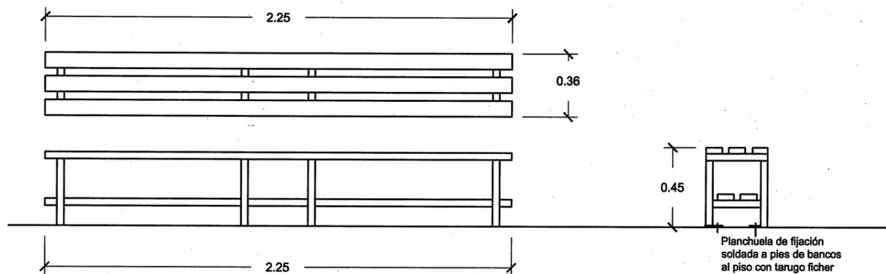
Banco de estructura fabricada en tubo de acero pintado, 40 x 40 x 1.5 mm., con soldadura interior, en color blanco
