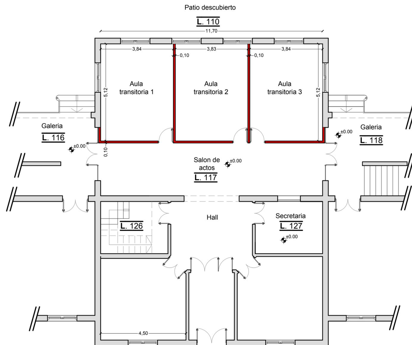
■ Muro existente    ■ Muro nuevo
