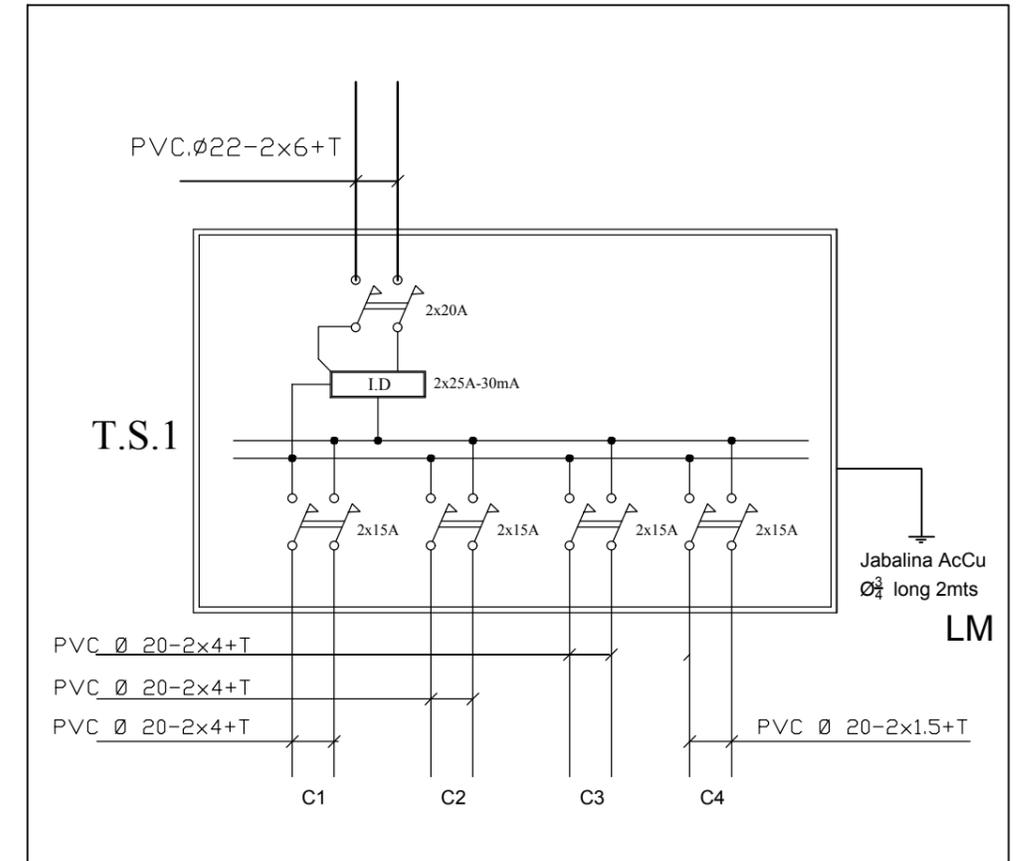
CONEXIÓN A TABLERO T.G. EXIST. MEDIANTE LINEA EMBUTIDA PVC Ø 22mm 2x6mm +T
