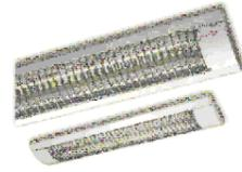
L3: cuerpo de chapa de acero lacado en epoxi - poliéster blanco. Cabezas de cierre inyectados en ABS. Reflector en lámina de aluminio anodizado y abrilantado. Louver inyectado en policarbonato blanco o cromatizado. Difusor: prismático em PC. 220 / 230 / 50 Hz. Bornes de conexión 2 P + T. Cables en sección 0,50 mm<sup>2</sup>. Dos Lámparas LED 18W. Tipo Lucciola o superior calidad.
