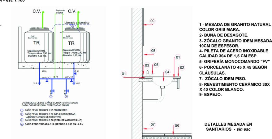
DETALLES TANQUES DE RESERVA - sin esc
