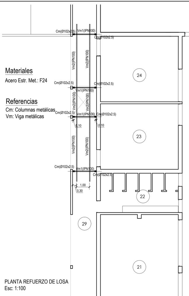
PLANTA REFUERZO DE LOSA
