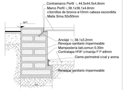
**Detalle de Anclaje de Cañeria s/Losa**
