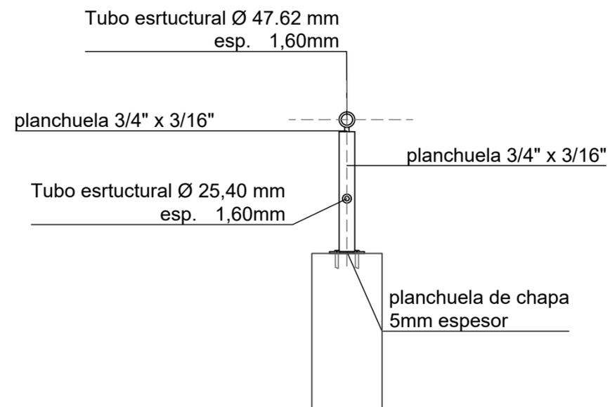
**Terminación:** pintura esmalte sintético semimate sobre antioxico (color a indicar por inspección).
