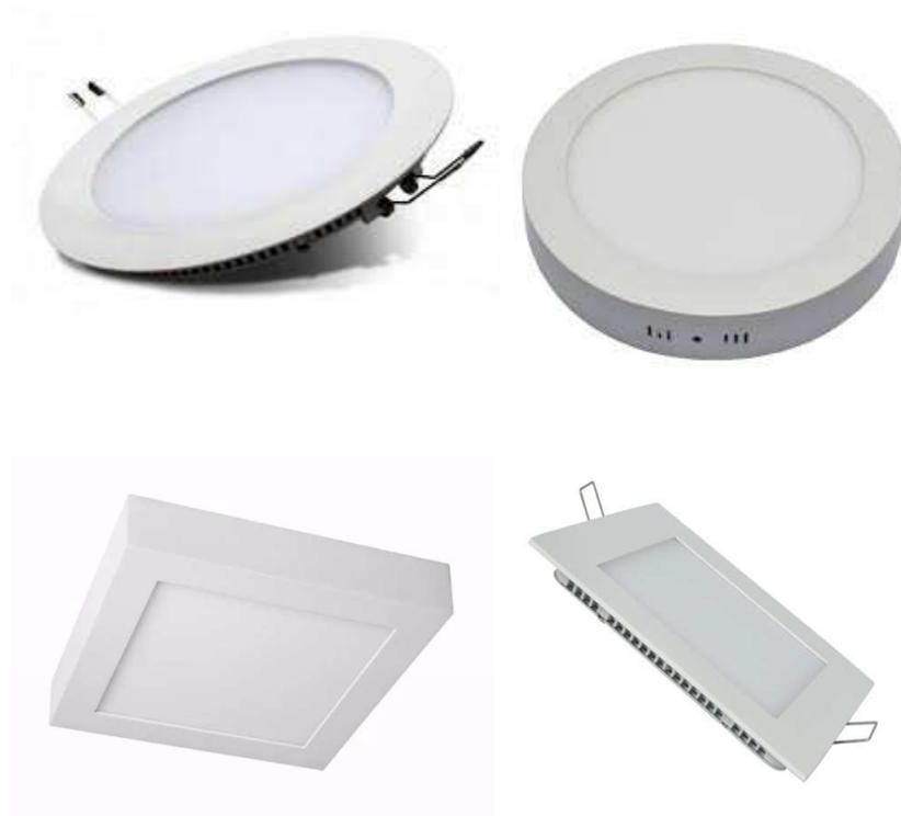
**Artefacto TIPO PL40:** Equipo de panel led de 48W 60x60, o circular, con disipador y alimentación directa a 220V con fuente, apto para aplicar en techo, construido en chapa de hierro estampada, tratado superficialmente con pintura epoxi termo convertible horneada a 200° C en color blanco. En los casos de sectores de cielo raso con loza se deberá utilizar el bastidor adaptador para instalar este tipo de artefacto en forma exterior.
