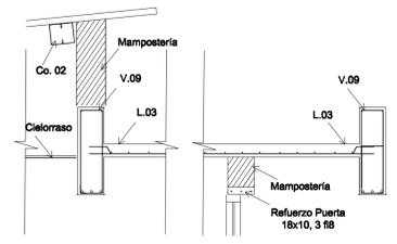
Detalle Viga V.L.01 - Losa L.V.01
