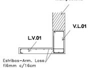
Detalle Viga V.L.02 - Losa L.V.02
