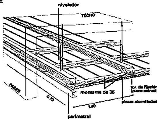
Esta estructura deberá estar perfectamente nivelada con un espacio entre los listones de estructura de aproximadamente 0.70 m. El sentido de la colocación deberá ser contrario al sentido de colocación del cielorraso. No se requiere sellador ya que las placas encajan simplemente a presión tipo machimbre y los tornillos de fijación quedan ocultos.
