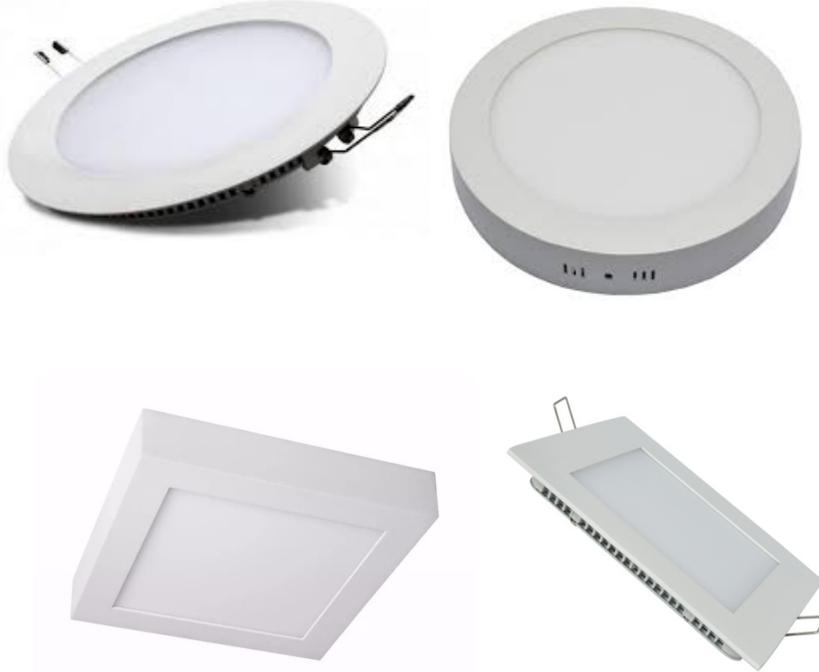
**Artefacto TIPO PL48:** Equipo de panel led de 48W 60x60, o circular, con dissipador y alimentación directa a 220V con fuente, apto para aplicar en techo, construido en chapa de hierro estampada, tratado superficialmente con pintura epoxi termoconvertible horneada a 200° C en color blanco. En los casos de sectores de cielo raso con loza se deberá utilizar el bastidor adaptador para instalar este tipo de artefacto en forma exterior.
