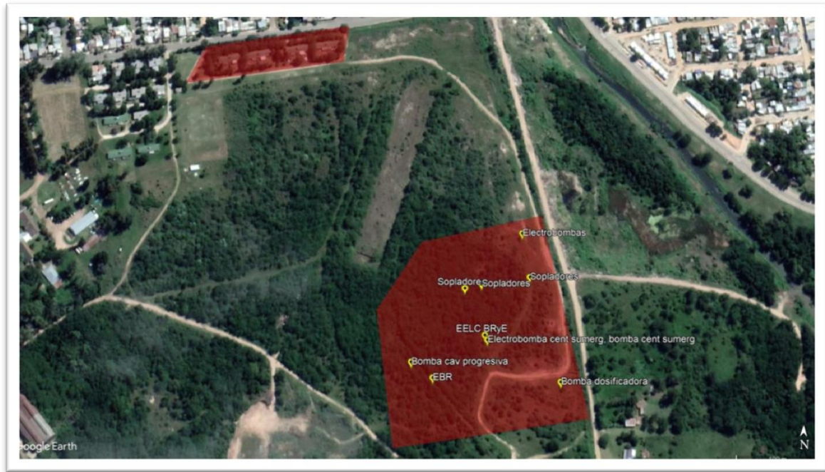
Figura 657. Ubicación de los equipos electromecánicos en el futuro predio de la Planta.
